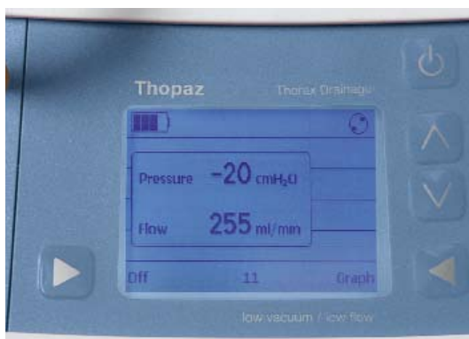
A beállított nyomás és a mért Flow valós idejű kijelzése
